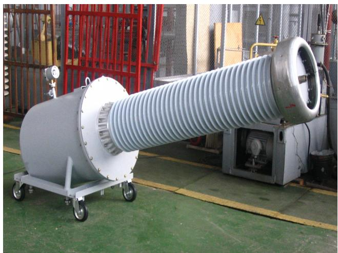
Испытательный трансформатор с элегазовой изоляцией ИОГ-300/100-І предназначен для использования в качестве источника высокого напряжения при проведении испытаний напряжением промышленной частоты электротехнического оборудования, обладающего большой электрической емкостью относительно земли.
